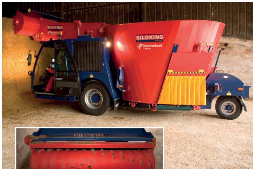
Det breda fråshuvudet kan hantera alla typer av material tack vare en fällbar fråshuv.
