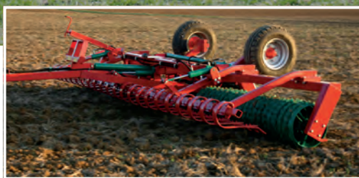
De flesta modeller kan utrustas med hydrauliskt reglerad lamellplanka.
